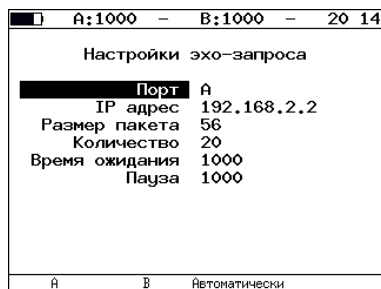
Рис. 7.36. Настройки теста Ping
