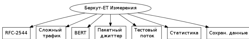
Рис. А.3. Структура меню «Беркут-ЕТ Измерения»
