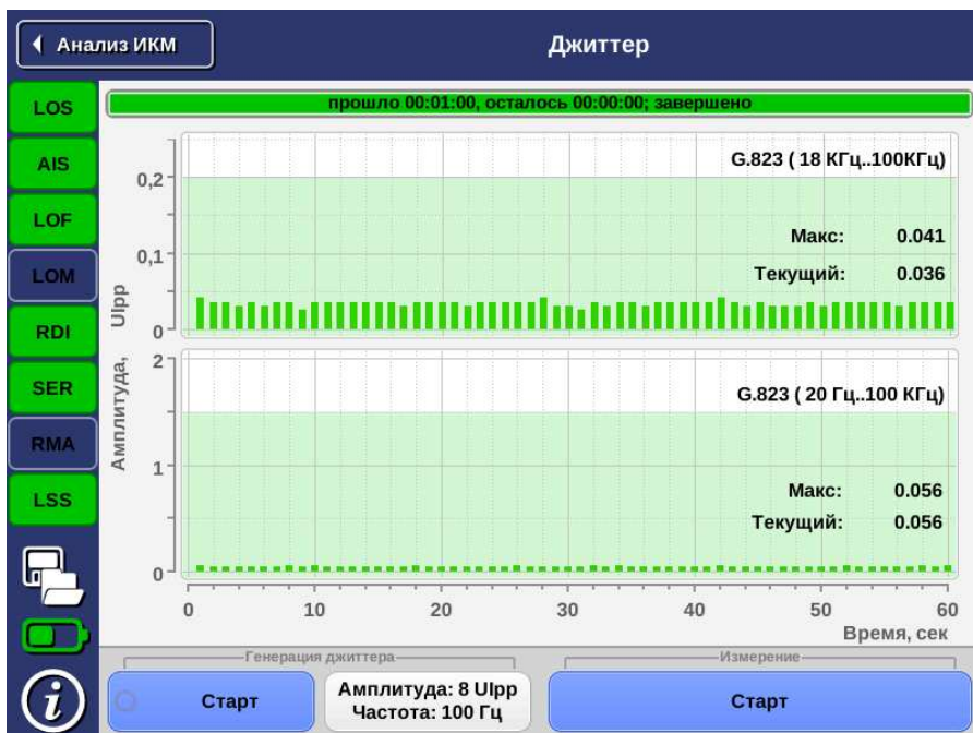
Рис. 11.5. Результаты измерения джиттера
