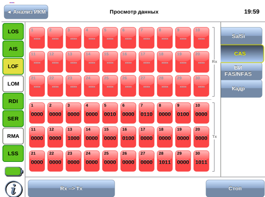
Рис. 13.2. Вкладка «Сигнальные биты CAS»
