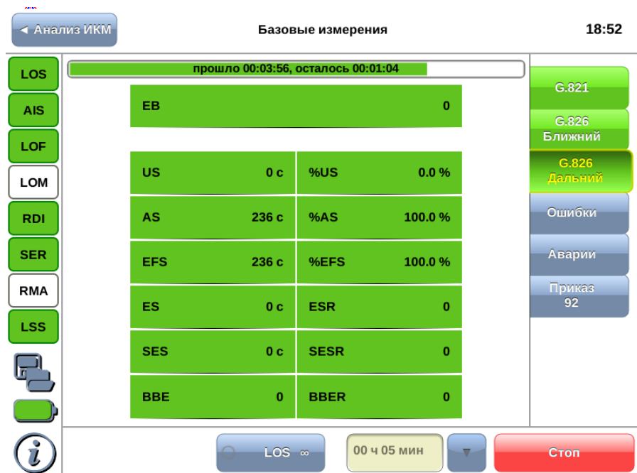
Рис. 8.9. Результаты измерений G.826 (дальний конец)
