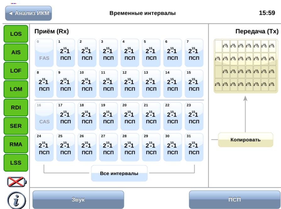
Рис. 7.1. Приложение «Анализ Е1 — Временные интервалы»
