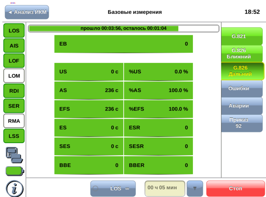
Рис. 8.9. Результаты измерений G.826 (дальний конец)
