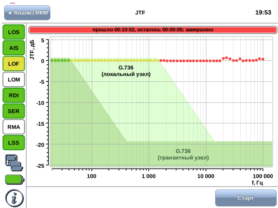
Рис. 11.6. Результаты измерения JTF
