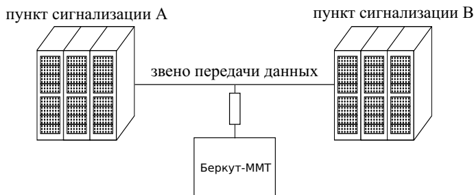
Рис. 2.1. Схема подключения к ИКМ-тракту
