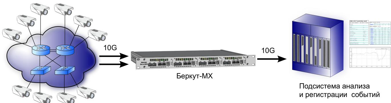
Набор анализаторов и серверов определяется условиями подключения: количеством источников, агрегацией и распределением трафика в точках установки.
