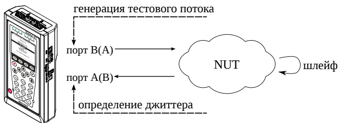
Рис. 12.2. Измерение джиттера. Схема 2
