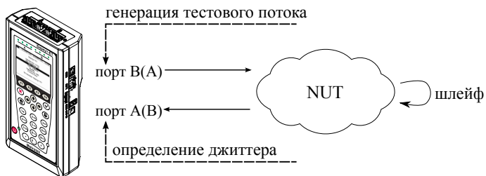
Рис. 12.2. Измерение джиттера. Схема 2
