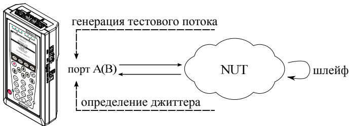
Рис. 12.1. Измерение джиттера. Схема 1
