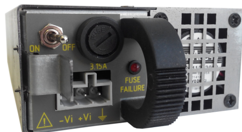
Рис. 6.3. Вид элементов управления БП и розетки питания
