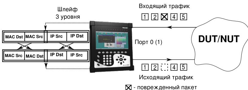
Рис. 8.3. Подключение шлейфа 3-го уровня для одного порта
