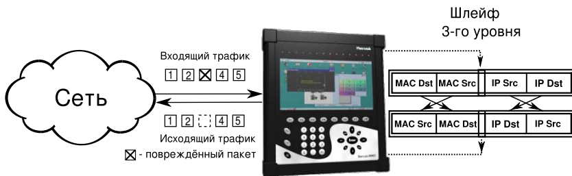
Рис. 9.3. Подключение шлейфа 3-го уровня для одного порта
