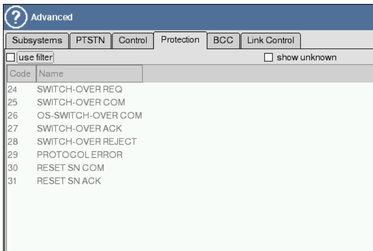
Рис. 6.14. Фильтрация по сообщениям протокола Protection
