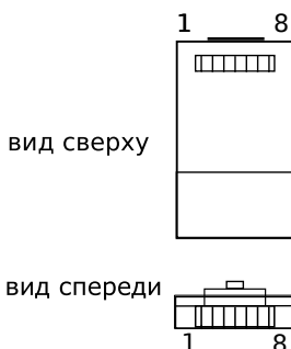
Рис. С.1: Схематическое изображение контактов разъема RJ-45
