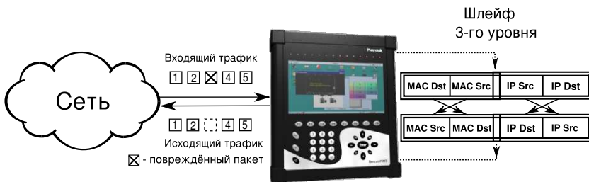
Рис. 11.3. Подключение шлейфа 3-го уровня для одного порта
