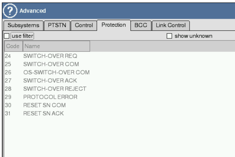
Рис. 5.14. Дополнительная настройка фильтров для V5: Protection
