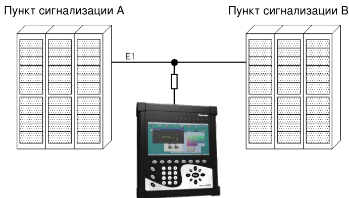
Рис. 3.1. Схема подключения к ИКМ-тракту
