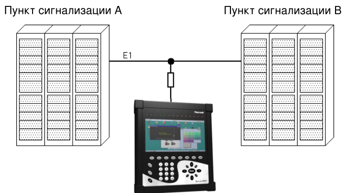
Рис. 3.1. Схема подключения к ИКМ-тракту
