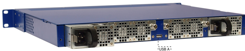
Рис. 5.2. Задняя панель коммутатора Metrotek X10-24
